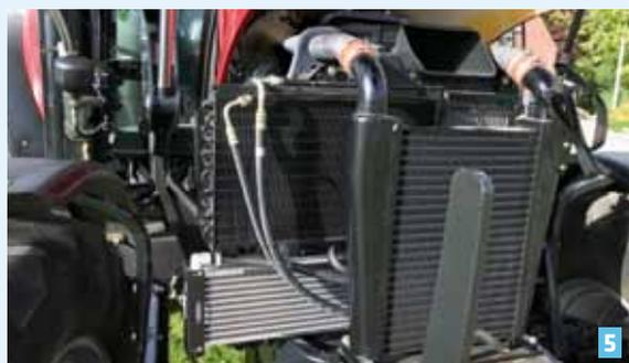
**5 | Manutenzione del trattore semplificata.** I sottotelai Trima sono montati in verticale. Questo consente di effettuare con facilità interventi di manutenzione su tutti i trattori moderni senza interferire con il sottotelaio o il meccanismo di bloccaggio.
